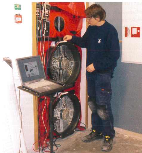
Fig 9 Fläktar monteras i en dörr. Fläktarna skapar övertryck eller undertryck på 50 Pa. Medelvärdet är ett mått på hur mycket som läcker ut genom väggar och tak.
